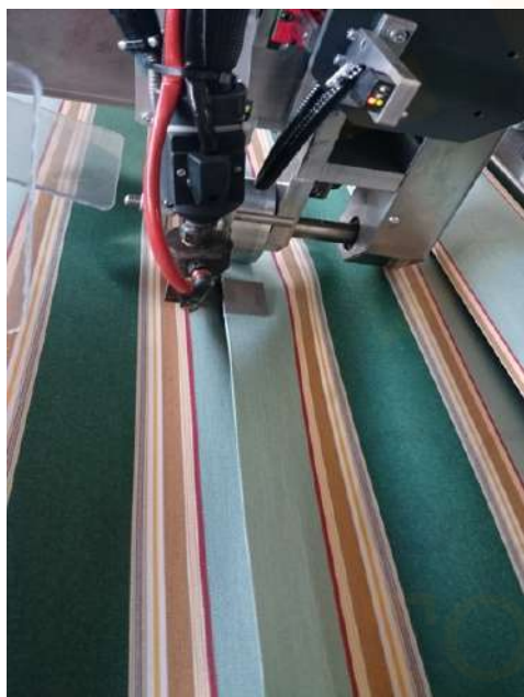
Corte de lona mediante máquina de ultrasonidos
