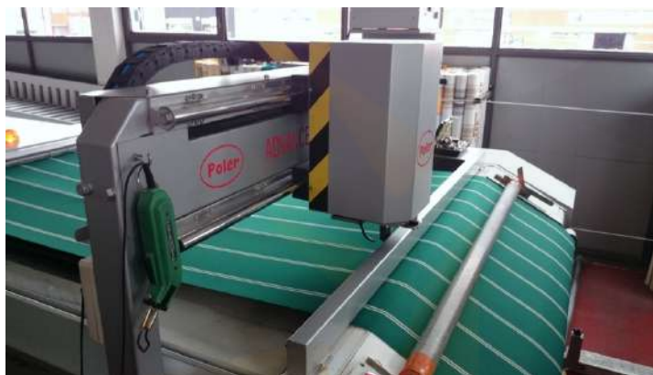
Corte de lona mediante máquina de ultrasonidos
